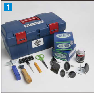
1 内面修理に必要なツール例
