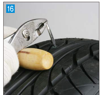
16 ドライバーの柄をテコにして、タイヤの外側に出た金属部分をプライヤーベンチで引き抜く
