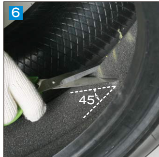
6 ハサミを使い、サイレントコアの凸部に斜め(45度位)に2ヶ所切れ込みを入れる ※作業にカッターは絶対に使用しないでください
