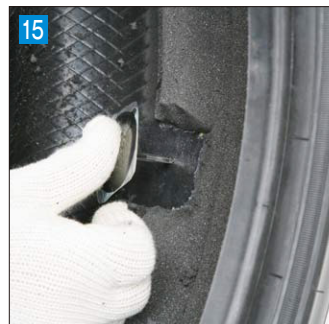
15 プラグパッチの金属部分をタイヤの内側から傷穴に挿入する
