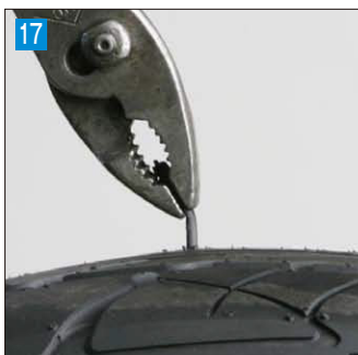
17 タイヤの内側を手で押さえ、外側に出たゴムを引っ張り、プラグパッチを密着させる
