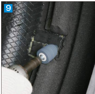
9 インナーライナーが露出するまでグラインダーで薄く均等にバフがけをする
